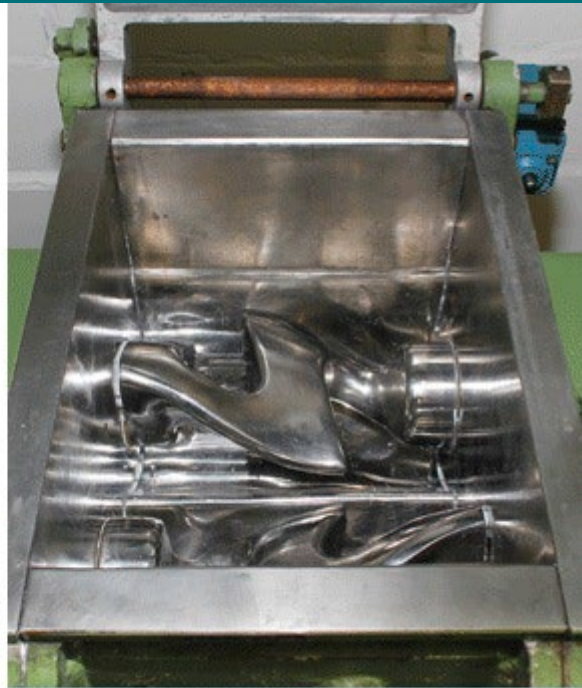
LINDEN Kneeter zum intensiven Scheren der Masse
