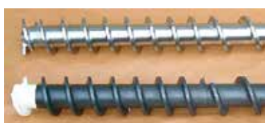
Bild 3 Keramikschnecke und Schnecke aus CVD beschichtetem Stahl
