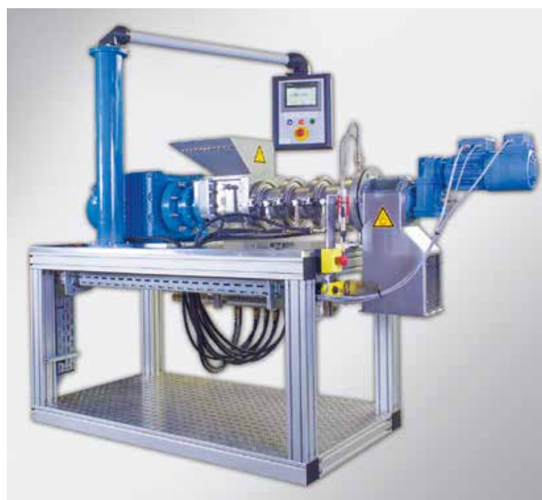
Bild 1 EXR 80, Hochdruck-Extruder mit zusätzlichem Rotations-Abschneider
